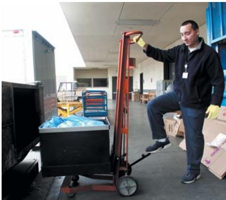
Una bomba hidráulica operada a pedal eleva la basura comprimida a la altura de la cintura.
