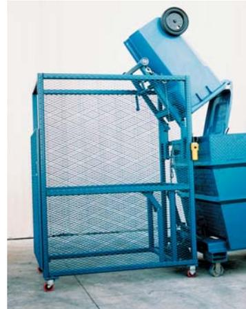
Vertedero de basura portátil – automático o de palanca manual.
